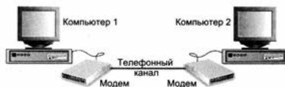
Рис. 1.3. Соединение двух компьютеров по телефону с помощью модемов
