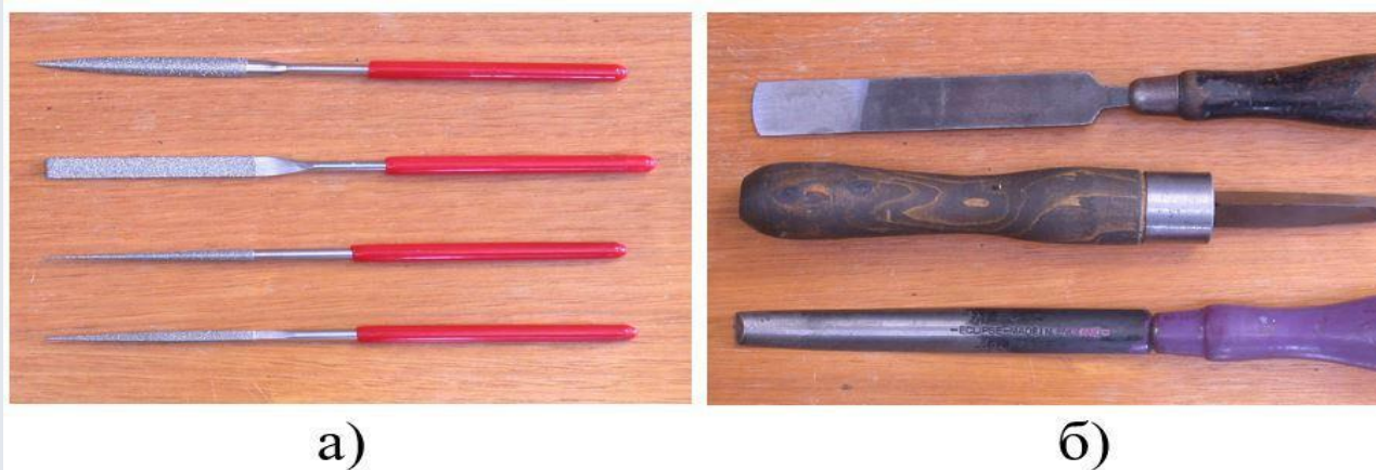
Рисунок 2.3.3.2 Інструменти і матеріали для механічного очищення поверхонь при паянні деталей: а) алмазні напилки; б) шабери: плоский, тригранний, напівкруглий; в) папір наждаковий
