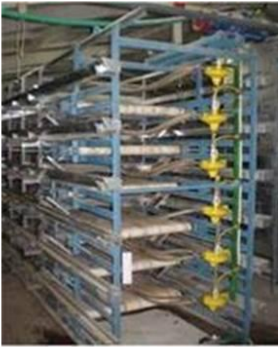
Рис. 11.14. Конвеєрна п'ятиярусна система видалення посліду
