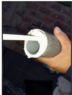
\*Pegar con espuma expansible el tubo de 2 pulgadas con el de 3 pulgadas.
