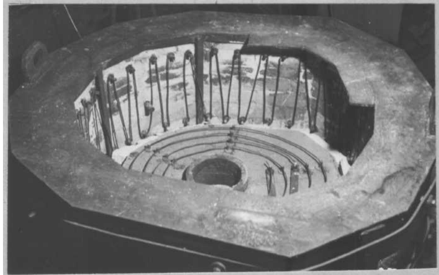
Рисунок 1 – Електрична нагрівальна піч для кришок дизелів МАН K6Z57/80F (кришка знята)
