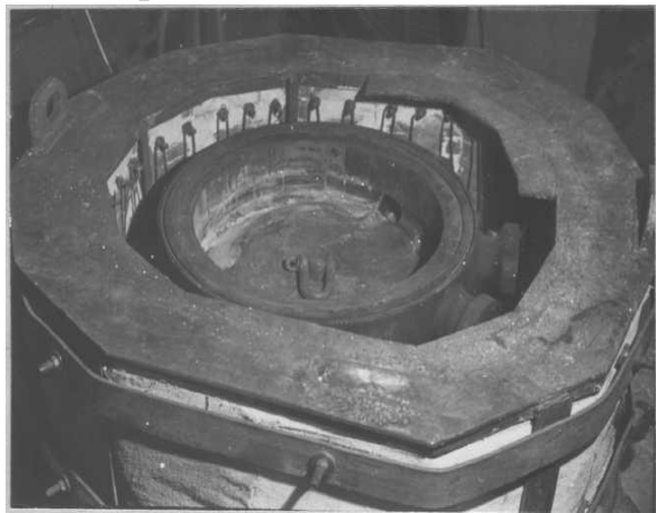
Рисунок 7 – Кришка дизелю МАН, що поміщена в електронагрівальну піч. Зовнішній вигляд відремонтованої кришки
