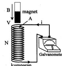
Gambar tersebut menunjukkan rangkaian alat-alat yang digunakan untuk percobaan GGL
