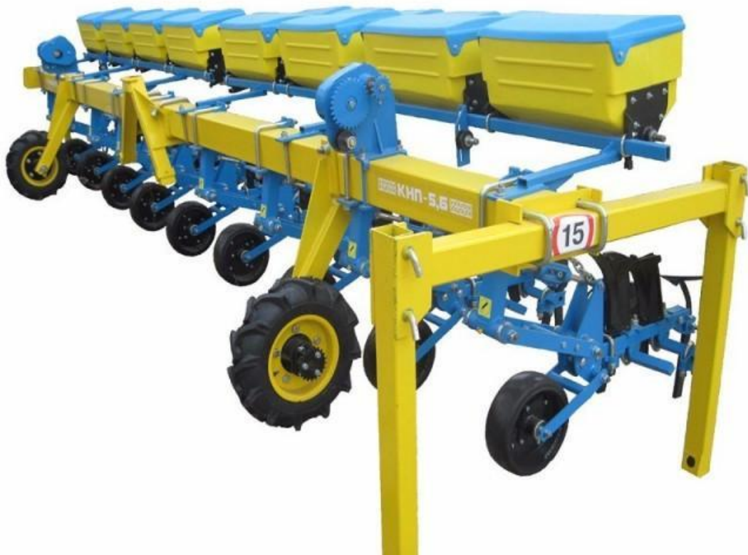
Рис.2.2. Культиватор навісний КНП-5,6 з системою внесення добрив (зовнішній вид)
