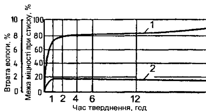
Рис. 10.1. Зміна міцності гіпсобетону залежно від його вологості і тривалості тверднення: 1, 2 за даними різних авторів
