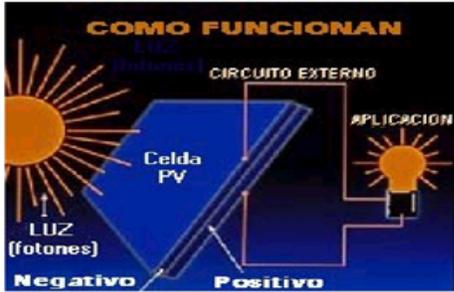
**Fig. 1 (Celda fotovoltaica que tiene como función primordial convertir la energía captada por el sol en electricidad a un nivel atómico)**
