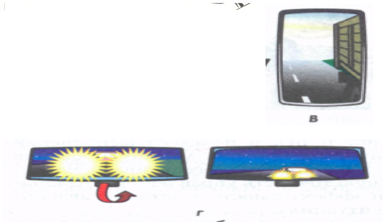
Рис.1.4 Правильне регулювання дзеркал заднього виду: а, в – положення відрегульованих дзеркал; б – перевірка правильності регулювання
