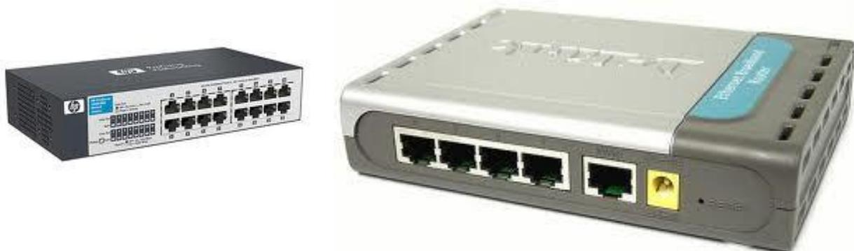
**ROUTER O ENRUTADOR:** Es un término inglés que puede traducirse como enrutador, ruteador o direccionador. Se trata de un dispositivo de hardware que se utiliza para interconectar computadoras que operan en nivel de red.
