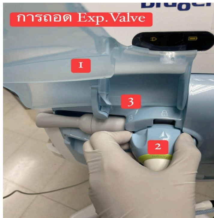
ภาพที่ 1 การแยกชิ้นส่วน Expire Valve ขั้นตอน 1-3
