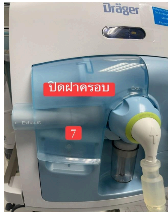
ภาพที่ 2 ขั้นตอนการประกอบ Expire Valve 7
