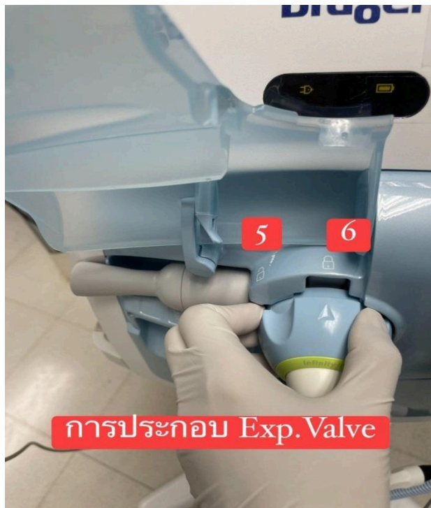
ภาพที่ 2 ขั้นตอนการประกอบ Expire Valve 5-6
