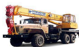
Автокран с гидроприводом подъема и поворота стрелы.
