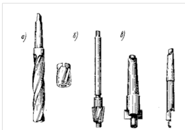
Мал. 4.26. Зенкери: а – цільний, б – насадний, в – зі вставними ножами
