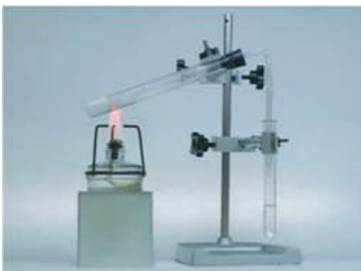
Мал. 21.2. Добування етанової кислоти в лабораторії
