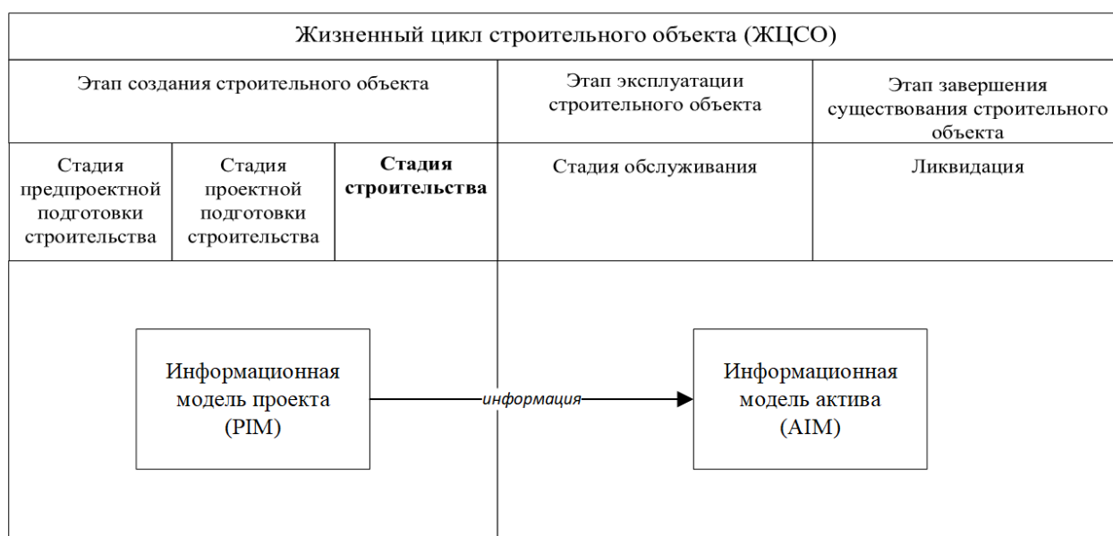
Рисунок 1 – Схема информационной модели строительного объекта
