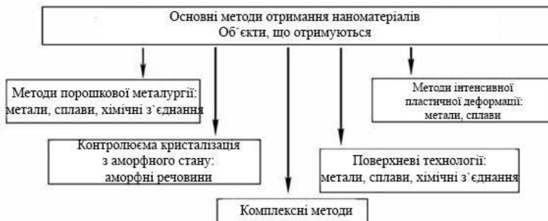
Рисунок 7.1 - Основні методи отримання об'ємних нанокристалічних матеріалів
