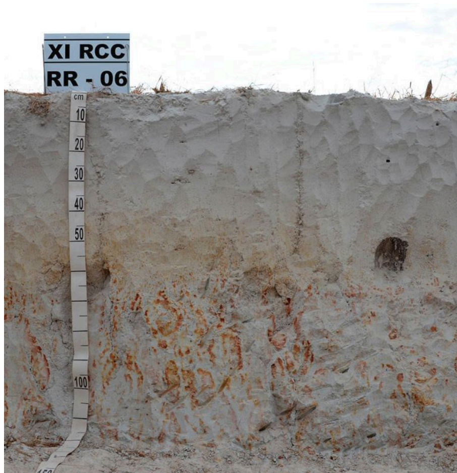
Figura A1. Imagem do perfil de solo classificado como PLANOSSOLO NÁTRICO Órtico vertissólico, textura média, A fraco, Ta, fase campo cerrado equatorial, relevo plano, município de Pacaraima, Roraima (Oliveira et al., 2018).
