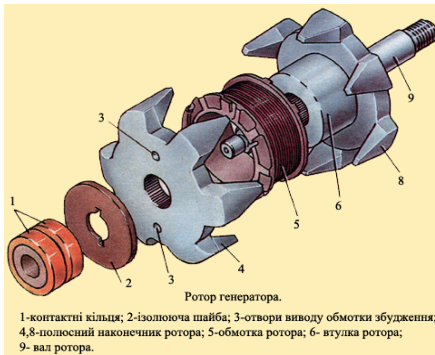
Рис. 33. Будова ротора генератора:
