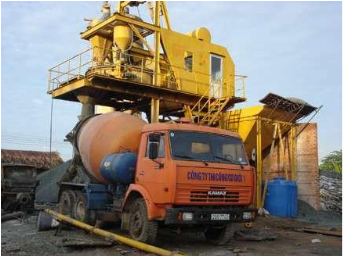
Trạm trộn bê tông
