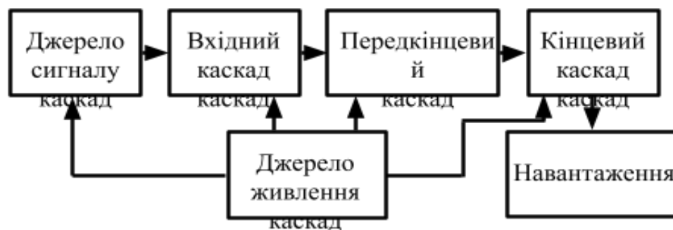
Рисунок 2.1 – Структурна схема підсилювача
