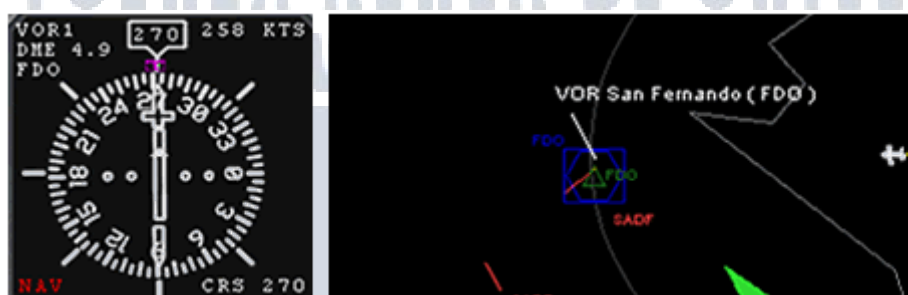
Figura 3: Indicación en un HSI y GPS, en este caso al ESTE de la estación VOR.
