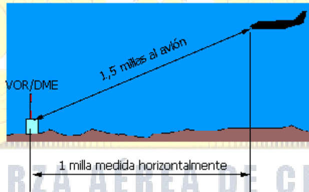
Figura 7: medición de distancia por DME
