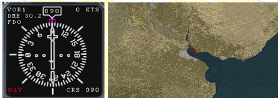
Figura 5: El HSI mostrando la radial y la distancia por DME, a la derecha la vista de mapa de la zona en que volamos
