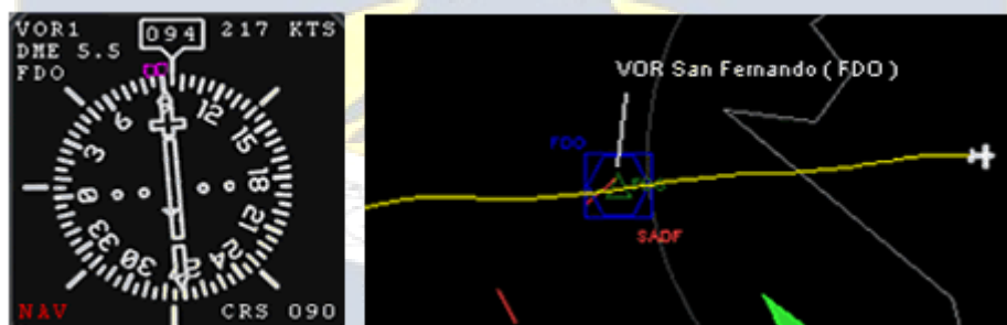
Figura 1: Indicación en un HSI y GPS, en este caso al ESTE de la estación VOR.
