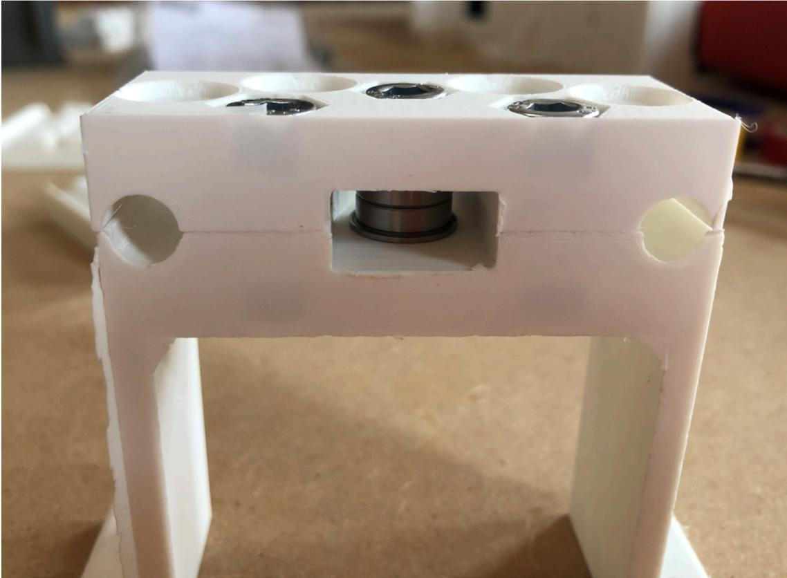
Die Umlenkrolle besteht aus 2 kleinen Kugellagern mit Flasch, die durch die mittlere Schraube gehalten werden.
