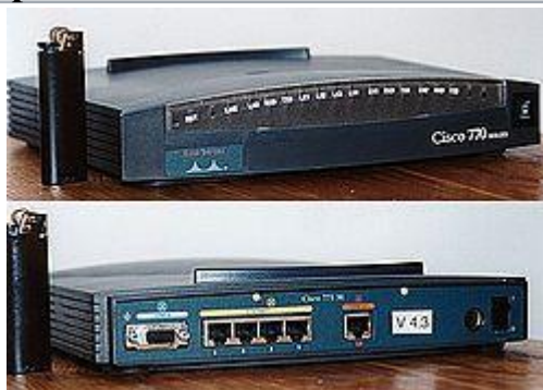
Мережевий шлюз із вбудованим комутатором. Вид спереду (вгорі) і ззаду (внизу).
