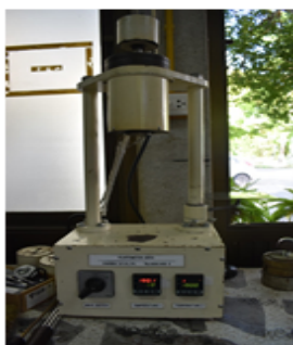
รูปที่ 2 แสดงเครื่องวัดดัชนีการไหล (Melt Flow Index) จากบริษัท Chareon TUT รุ่น Plastometer (MFR1)
