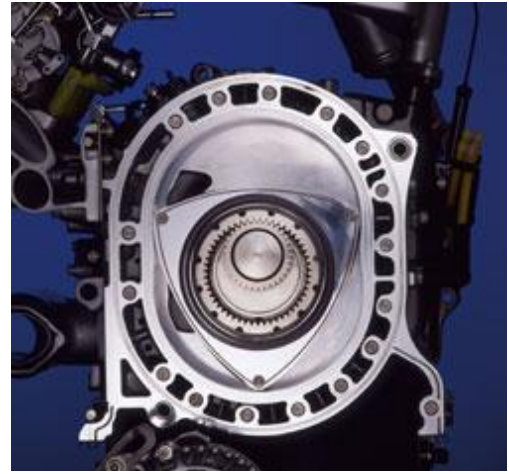
Şekil 15. Mazda tarafından ileri teknoloji ile geliştirilmiş wankel motoru [21]
