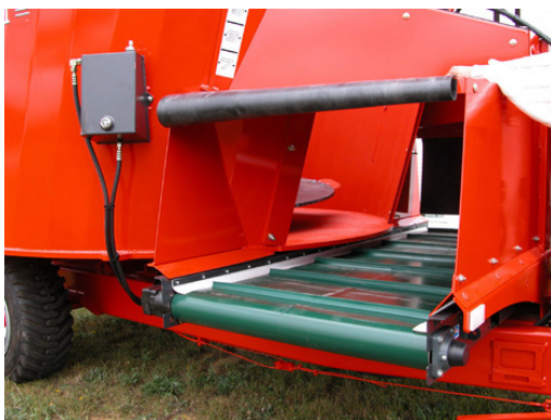
Рис. 8.5. Загальний вигляд вивантажувального вікна
