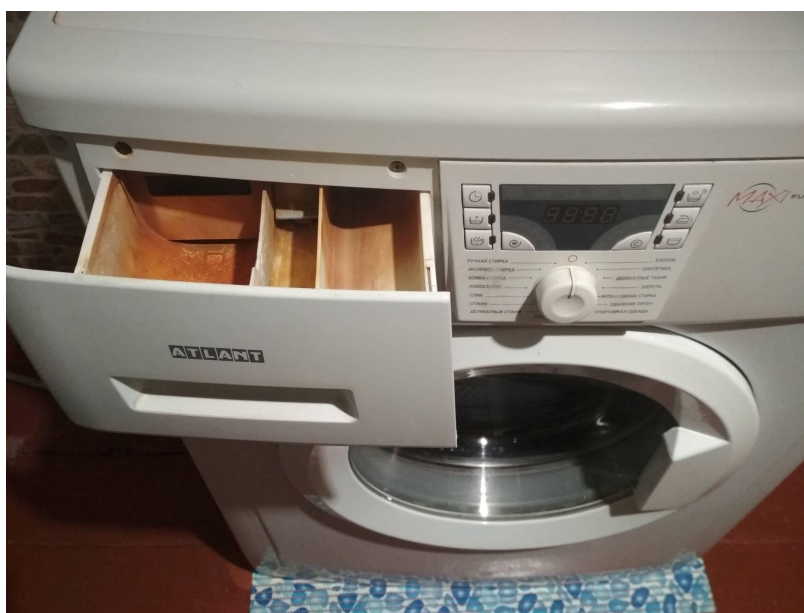
Рисунок 2 – Такой вид имеет бытовая техника и посуда после длительного применения воды из трубопровода
