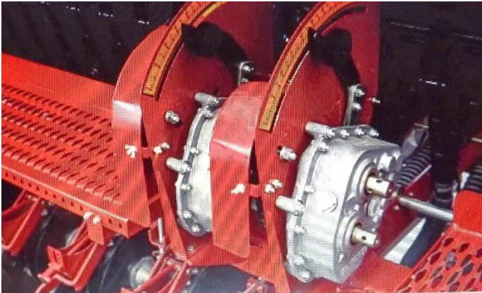
Рис. 8. Варіатори для плавного регулювання норми висіву насіння і міндобрив
