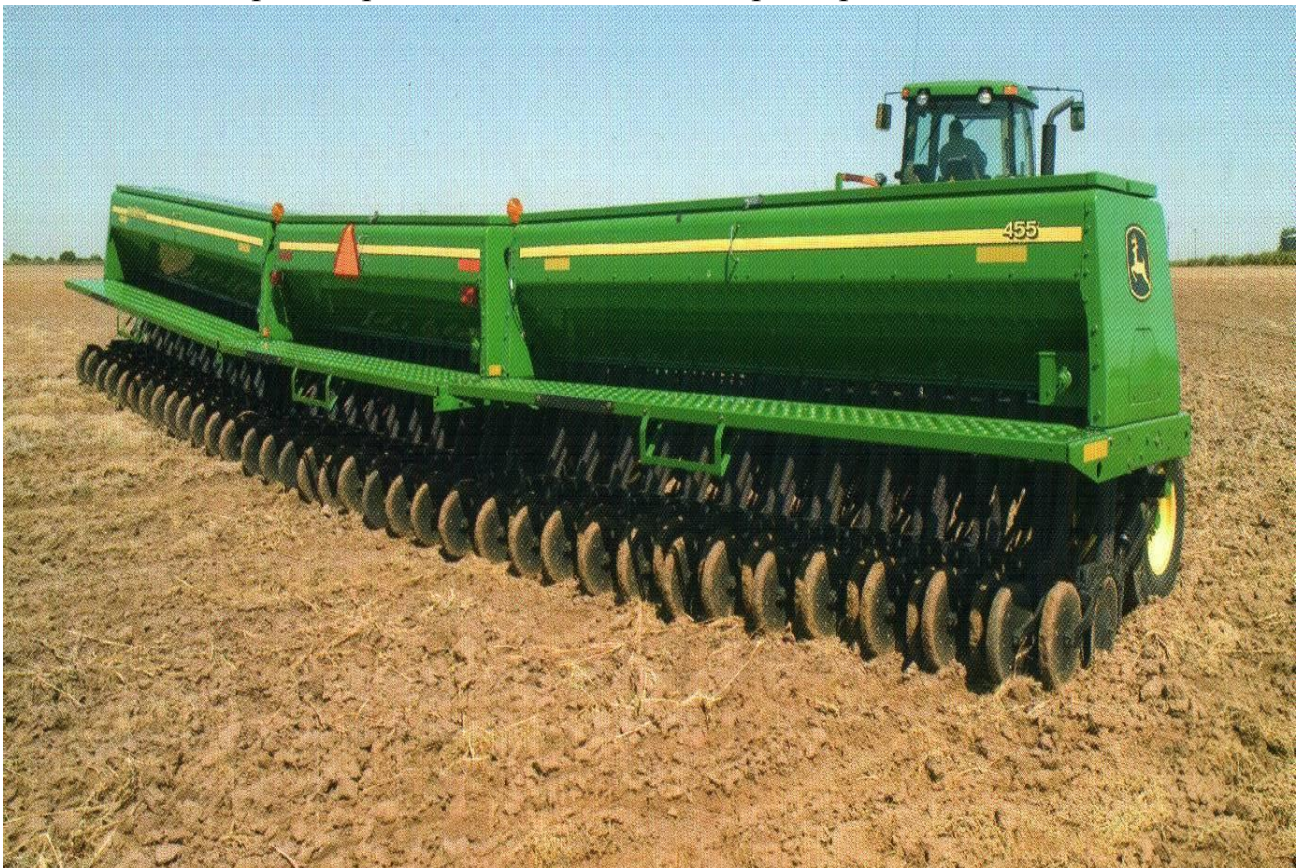
Рис.21. Зернова механічна рядкова трисекційна сівалка JOHN DEERE 455
