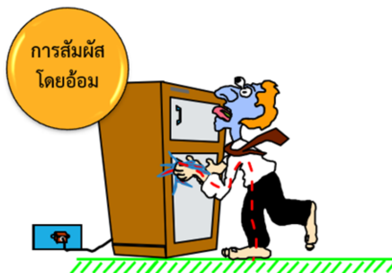
รูปที่ 3 การสัมผัสส่วนที่มีกระแสไฟฟ้าโดยอ้อม
