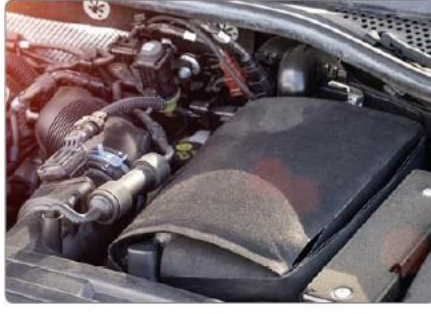
Görsel 4.22: Üstü ısı yalıtkanı kapakla örtülmüş motor
