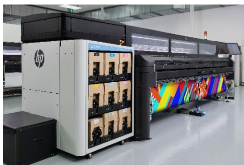
Tiskárna HP Latex FS60W s šířkou 3,2 m a bílým inkoustem
