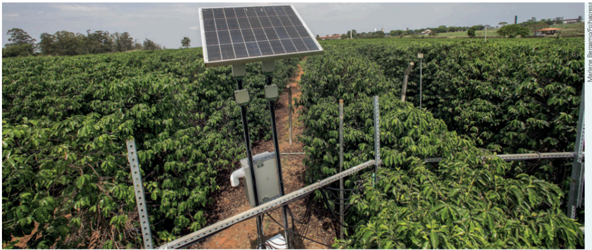
Figura: Sítio experimental da Empresa Brasileira de Pesquisa Agropecuária (Embrapa) onde sensores monitoram o crescimento de pragas, as condições climáticas e a umidade do solo em um cafezal, em Jaguariúna (SP), 2018.
