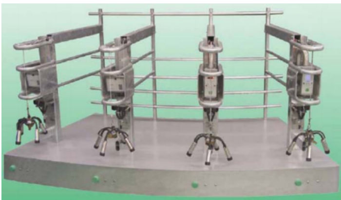
Рис. 13.4. Загальний вигляд та схема розміщення корів на доїльній установці «Карусель» типу «Global 90»
