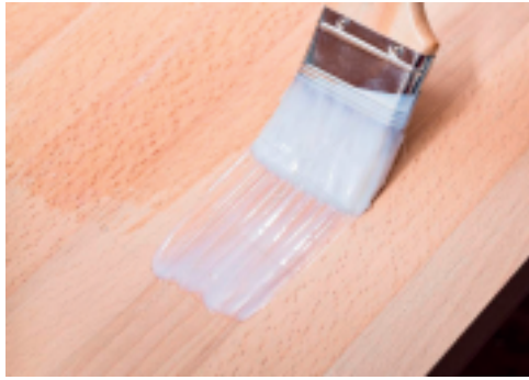
Рис.1.3. Нанесення лаку на дерев'яну поверхню за допомогою пензля
