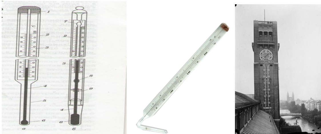
Рис.2.1 Типы ртутных термометров и самый большой термометр в Германии (Мюнхен,1930) 1-пробка, залитая гипсом; 2-оболочка; 3-шкала; 4-капилляр; 5-нижняя часть термометра; 6-резервуар; 7.8- расширения капилляра; 9-дополнительная шкала
