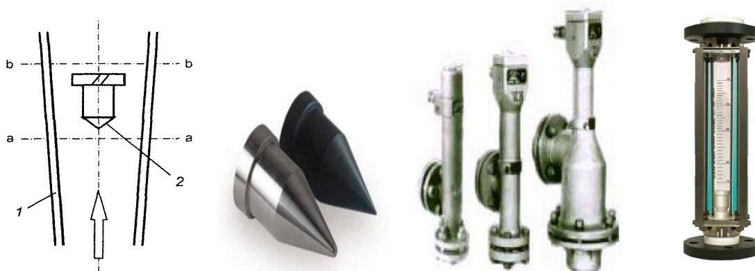
Рис.4.2 Схема ротаметра, поплавки и внешний вид ротаметров
