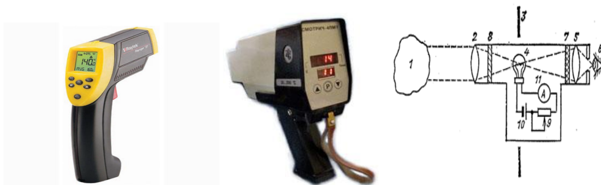
Рис.2.14. Квазимонохроматический пирометр с исчезающей нитью
