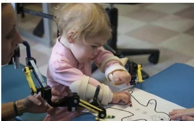
Екзоскелет, надрукований на 3D принтері для дівчинки з атрофованими м'язами рук
