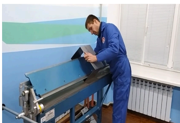
22. Відтискаємо та виймаємо заготовку від основи листогибочного верстату
