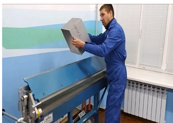
22. Відтискаємо та виймаємо заготовку від основи листогибочного верстату
