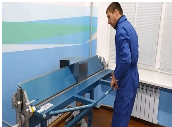
21. За допомогою нижньої основної планки листогибочного верстату виконуємо згинання кута 90^\circ заготовки.
