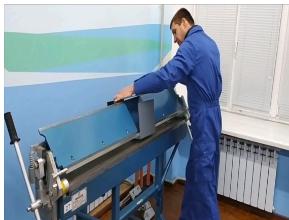
21. За допомогою нижньої основної планки листогибочного верстату виконуємо згинання кута 90^\circ заготовки.
