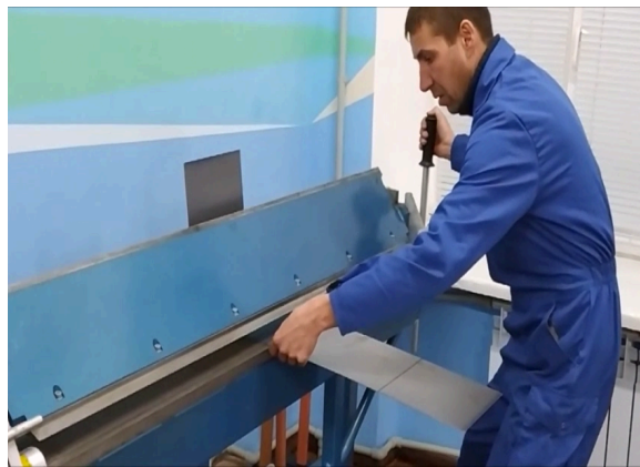
20. Встановлення заготовки на основу листогибочного верстату відповідно розмітки та притискання верхнім притискним упором
