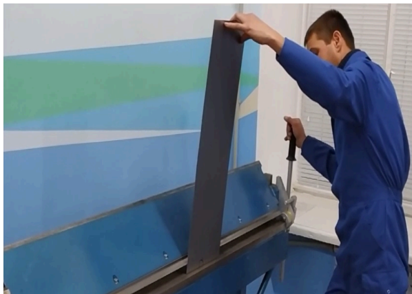
19. Відтискання верхнього притискного упору від основи листогибочного верстату
