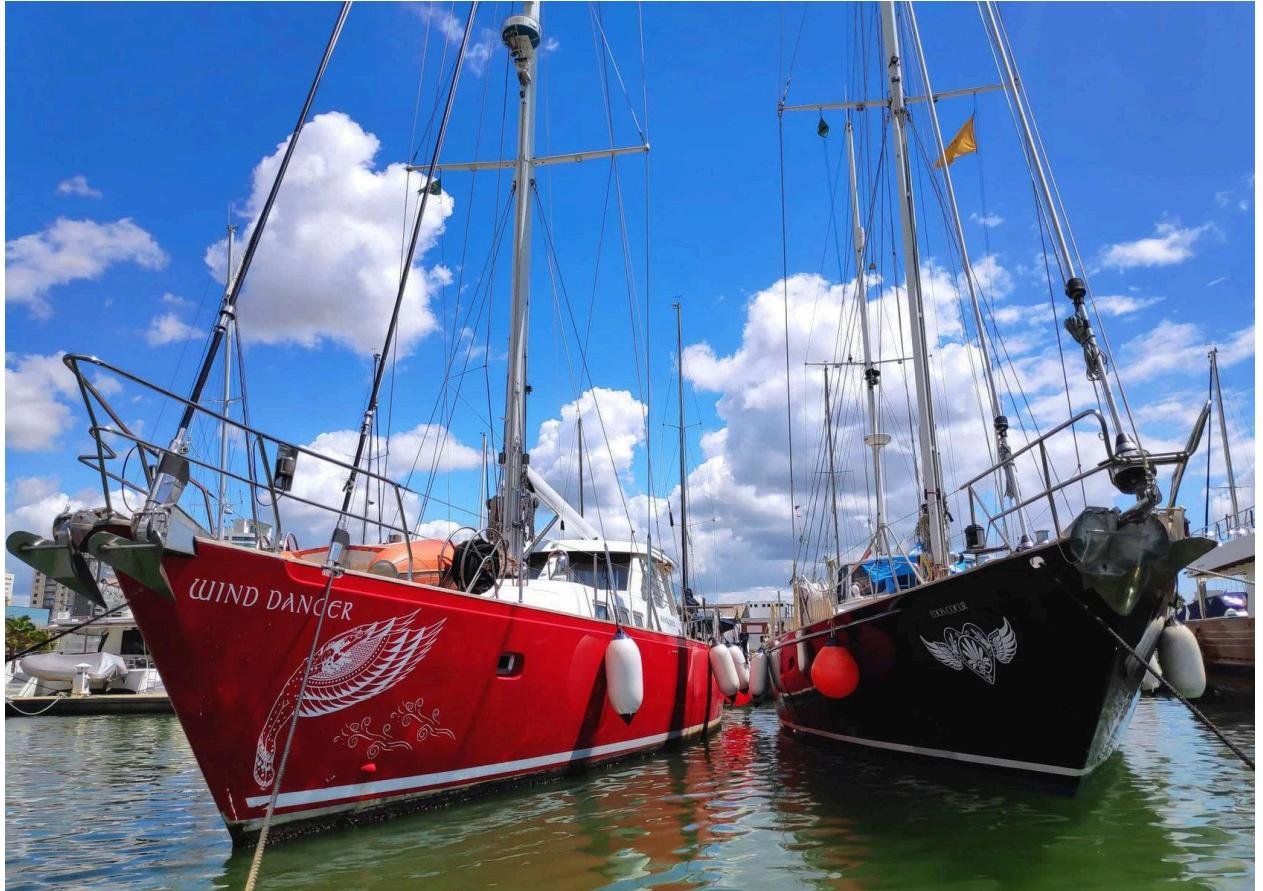
Двухмачтовая парусно-моторная яхта «Mon Coeur» была построена в Германии на верфи DÜBBEL & JESSE. Она имеет алюминиевый корпус с длинной килевой линией оборудованный дополнительным тримером.
