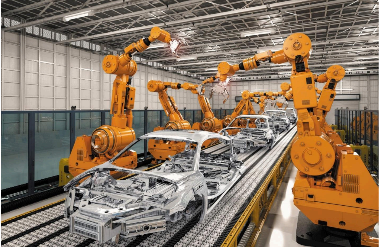
Рисунок 1. – Автоматический цех сварки кузовов автомобилей
