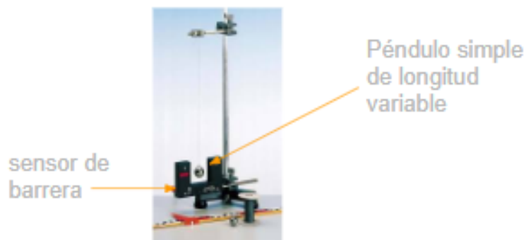
Figura 1: Diagrama del dispositivo experimental utilizado. El sensor de barrera es colocado en el extremo inferior de un péndulo simple de longitud variable de tal forma de poder medir el periodo de oscilación del mismo.
