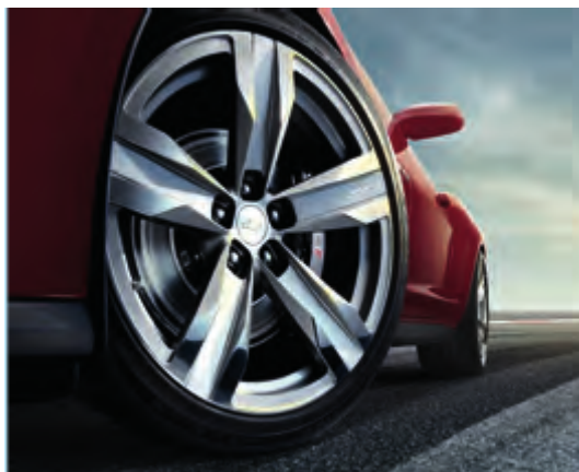
Рис. 31.2. Колесо автомобиля имеет две кинетических энергии – вращательную и поступательную
