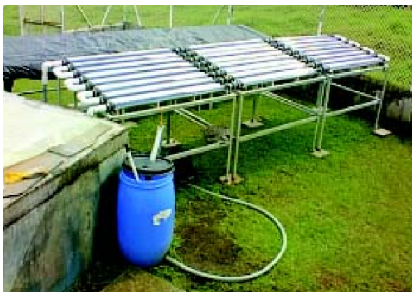
Figura. 1. Colector solar con ensayo de agua residual industrial textil.
