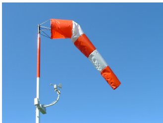
Anemômetro - registra a velocidade dos ventos.
