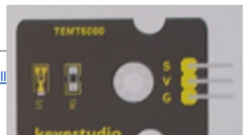
Este dispositivo, a través del fotoresistor incluido y la circuitería que lo acompaña, permite de manera fácil ver la luminosidad existente. Lo que nos proporciona es una señal analógica.
