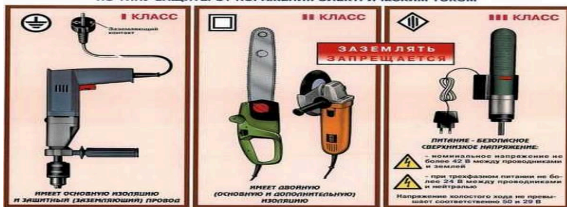
КЛАССЫ ЭЛЕКТРИФИЦИРОВАННОГО ИНСТРУМЕНТА ПО ТИПУ ЗАЩИТЫ ОТ ПОРАЖЕНИЯ ЭЛЕКТРИЧЕСКИМ ТОКОМ
