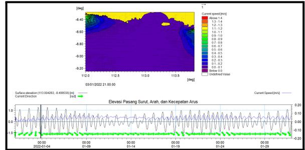
**Gambar 5.** Kecepatan arus pasut pada saat surut
