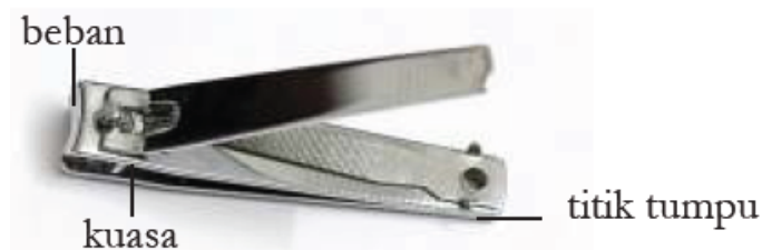
Gambar 3.14 Pemotong kuku, contoh pengungkit jenis 3
