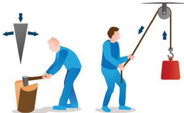
Gambar 3.7 Membelah kayu dan menarik ember air, contoh penggunaan pesawat sederhana
