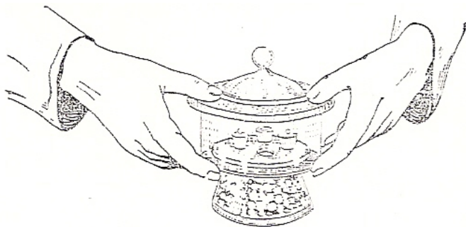
Рис. 1.45. Положення рук під час перенесення ексикатора
