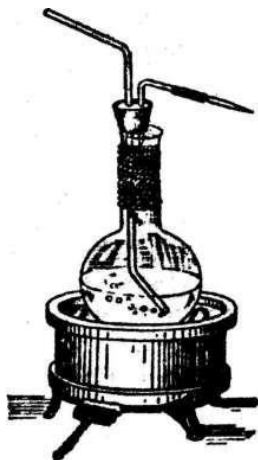
Рис. 1.16. Нагрівання води в промивалці
