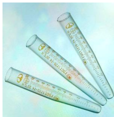
Рис. 1.1. Проста та градуйована пробірки
