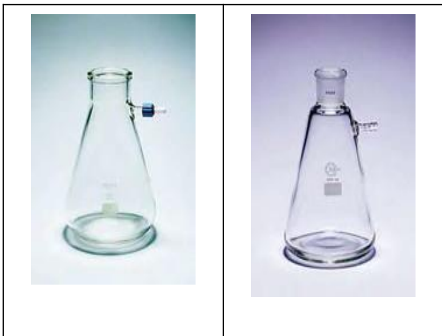
Рис. 1.18. Колба для фільтрування під вакуумом (Бунзена)
