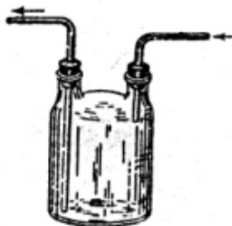
Рис. 1.29. Запобіжна склянка до водоструменевого насоса
