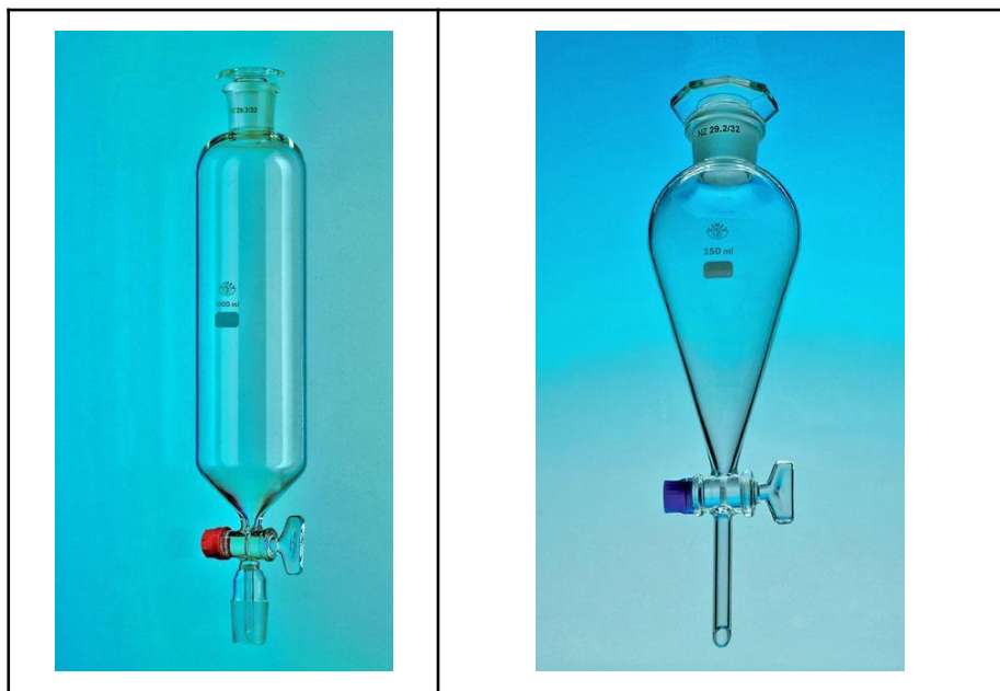
Рис. 1.8. Розподільчі (ділильні) лійки
