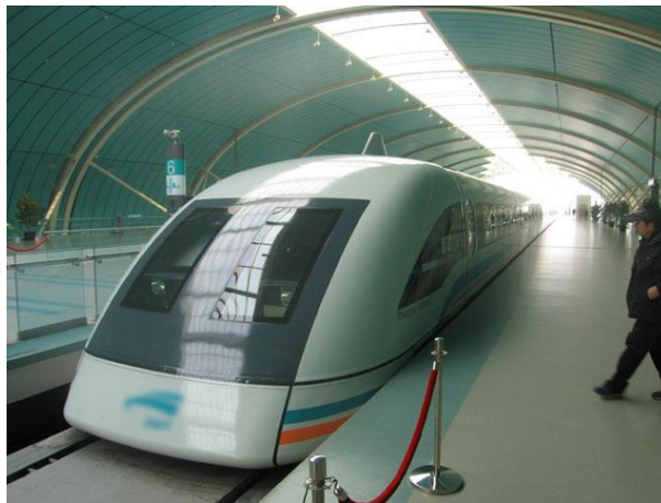
Figure 1 : Le Transrapid rejoint l'aéroport au cœur de Shanghai en moins de 8 minutes, à 250 \text{ km.h}^{-1} en moyenne, avec une vitesse maximale de 400 \text{ km.h}^{-1} .
